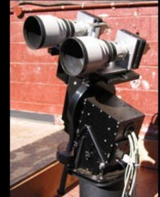
XO: 20 cm'lik iki özdeş teleskop, 7° 25".4 / piksel, Haleakala / Maui, 8 gezegen
