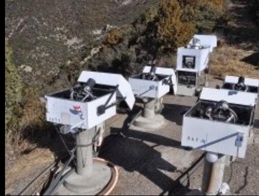
Hungarian Automated Telescope Network (HAT-Net): 11 cm'lik teleskoaplardan oluşan bir düzenek → 64° / kamera. Mount Hopkins / Arizona, Kitt Peak / Hawai, Avustralya, Namibya ve Şili'de kurulu 5 düzeneikle tüm gökyüzü! 2001 - ?, 152 gezegen!
