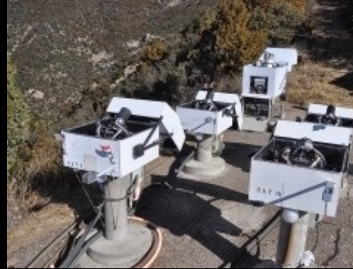
Hungarian Automated Telescope Network (HAT-Net): 11 cm'lik teleskoplardan oluşan bir düzenek → 64° / kamera. Mount Hopkins / Arizona, Kitt Peak / Hawai, Avustralya, Namibya ve Şili'de kurulu 5 düzenekle tüm gökyüzü! 2001 - ?, 152 gezegen!
