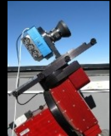
Kilo-Degree Extremely Little Telescope (KELT): 4.2 cm'lik küçük bir kamerayla 26x26°'lik bir görüş alanı. Sutherland / Güney Afrika ve Winer Gözlemevi'nde iki teleskop, 26 gezegen
