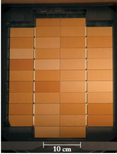
(a) 40 CCD (charge-coupled device) ile oluşturulmuş mozaik
